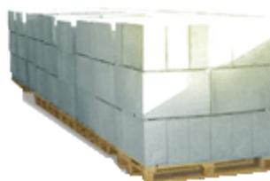
Строительный материал "пеноблок" - легкий ячеистый бетон, получаемый в результате твердения раствора, состоящего из цемента, фибры, песка и воды, муки известняка а также пены. Производство пеноблоков - это высокотехнологичный процесс. Эта пена обеспечивает необходимое содержание воздуха в бетоне и его равномерное распределение во всей массе в виде замкнутых ячеек. Пену получают из пеноконцентрата. Фибра позволяет пеноблоку становиться в 5 раз крепче по
